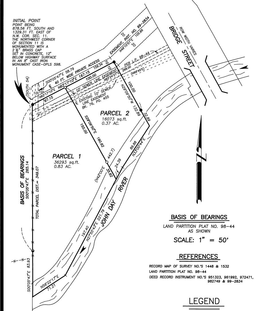
2. THE MEASURED BEARINGS AND/OR DISTANCES SHOWN ALONG THE PARTITION BOUNDARY ARE THE SAME AS SHOWN ON LAND PARTITION PLAT NO. 98-44.
